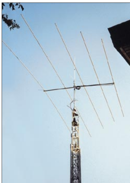
Bild 2: LP5 in etwa 10 m Höhe auf dem noch eingefahrenen Mast
